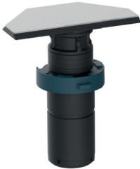
Besonders große Duschflächen ab einem Schenkelmaß von 1000 mm kannst du mit sechs oder mehr Montagefüßen stabil installieren. Die zusätzlichen Füße werden – anders als die Montagefüße in den Ecken – vorgespannt an den Längsseiten verklebt. Nach dem Ausrichten der Dusche löst du die Vorspannung einfach per Zug am Seil aus, die Füße geben zusätzlichen Halt.
